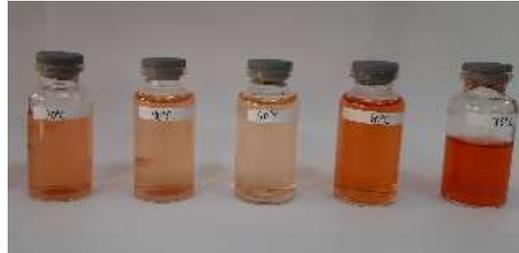
Larutan *congo red* setelah adsorpsi untuk penentuan suhu pada kondisi optimum (dari kiri ke kanan 30, 40, 50, 60 dan 70 °C).
