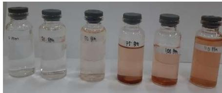
Larutan *congo red* setelah adsorpsi untuk penentuan konsentrasi pada kondisi optimum (dari kiri ke kanan 0, 25, 50, 75, 100 dan 110 mg/L).
