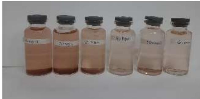
Larutan *congo red* setelah adsorpsi untuk penentuan waktu kontak kondisi optimum (dari kiri ke kanan 10, 20, 30, 40, 50 dan 60 menit).
