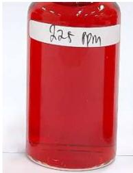
Larutan *congo red* sebelum adsorpsi untuk penentuan suhu pada kondisi optimum
