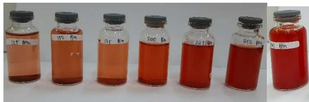
Larutan *congo red* setelah adsorpsi untuk penentuan konsentrasi pada kondisi optimum (dari kiri ke kanan 125, 150, 175, 200, 225, 250 dan 300 mg/L).
