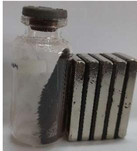
**Gambar 8.** Hasil Sintesis Fe<sub>3</sub>O<sub>4</sub>
