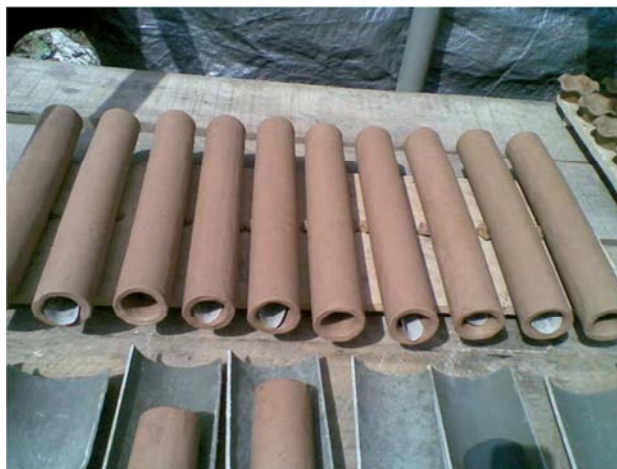
Gambar 4.1. Filter keramik yang terbuat dari campuran tanah liat, zeolit dan serbuk besi pada berbagai komposisi.
