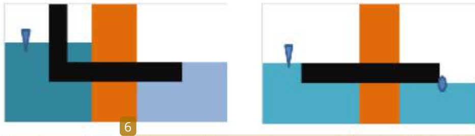
Gambar 5.12. Pintu air leher angsa posisi retensi air (a), pintu dirubah menjadi drainase (b)
