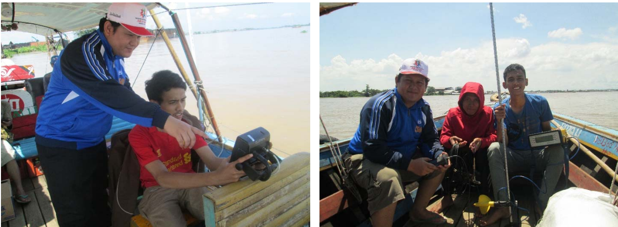
Gambar 2. Proses pengukuran bathimeri dan kecepatan aliran di Sungai Musi (Sumber: Dokumentasi penulis)
