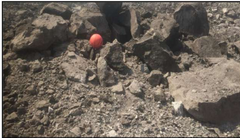
Gambar 4. Hasil peledakan bottom air deck
