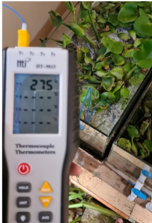
Gambar 6 Pengukuran Suhu Air Limbah Menggunakan Thermocouple
