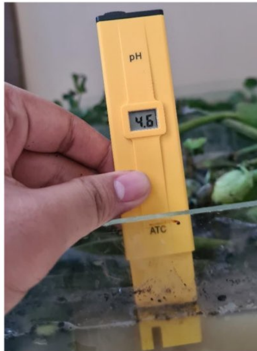
Gambar 7 Pengukuran pH Air Limbah Menggunakan pH Meter
