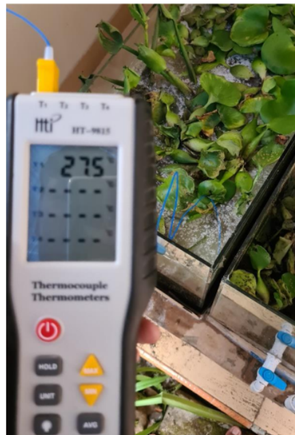
Gambar 6 Pengukuran Suhu Air Limbah Menggunakan Thermocouple
