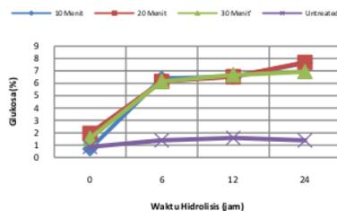
**Gambar 6.** Kadar Glukosa (%) setelah Hidrolisis untuk Sampel 110 °C
