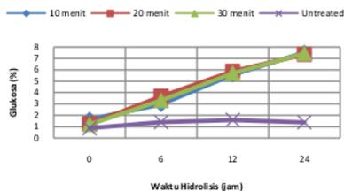
**Gambar 8.** Kadar Glukosa (%) setelah Hidrolisis untuk Sampel 150 °C
