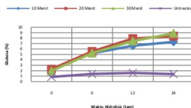
**Gambar 7.** Kadar Glukosa (%) setelah Hidrolisis untuk Sampel 130 °C
