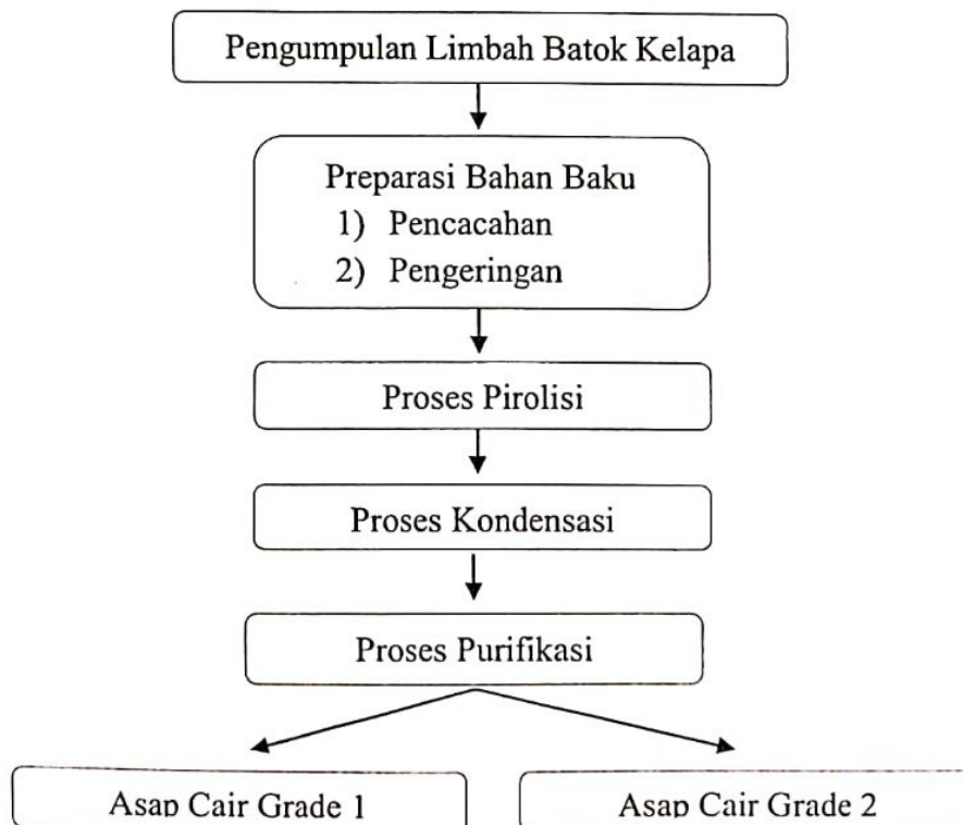
Gambar 4.2. Proses Pengolahan Tempurung Kelapa Menjadi Disinfektan
