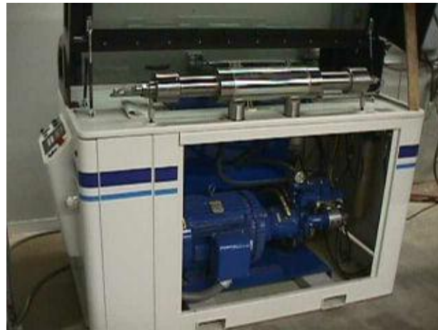
Gambar 2.4. Salah satu contoh intensifier pump “Ingersol Rand” SL-IV 50hp.
