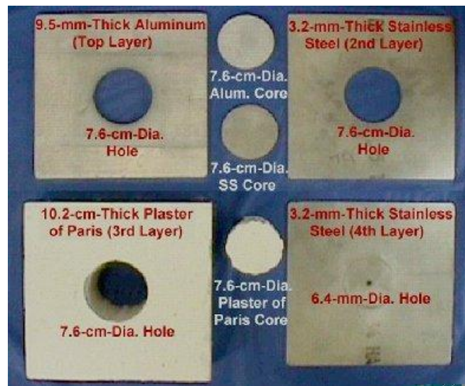
Gambar 3.16. Perbandingan lubang dan intinya yang dibuat dengan ACJ pada tekanan 207-MPa.
