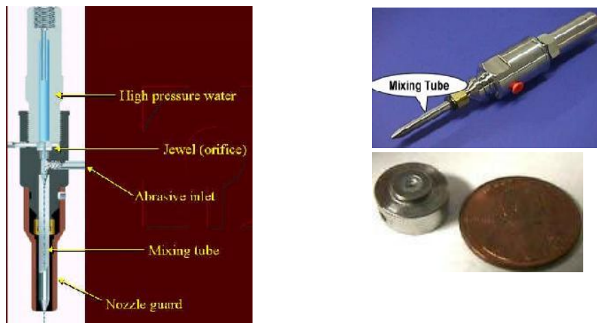
Gambar 3.2. Skema nozzle abrasive jet yang umum (kiri), tabung pencampur/ mixing tube (kanan atas), dan jewel diletakkan pada steel insert (kanan bawah) .
