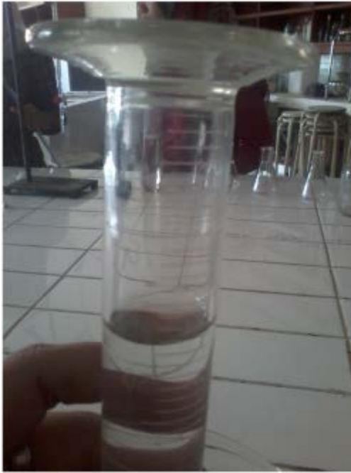
Peralatan untuk mengukur volume gas hidrogen yang dihasilkan
