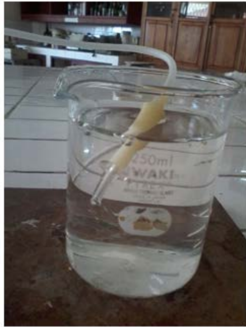
Peralatan untuk mengukur volume gas hidrogen yang dihasilkan
