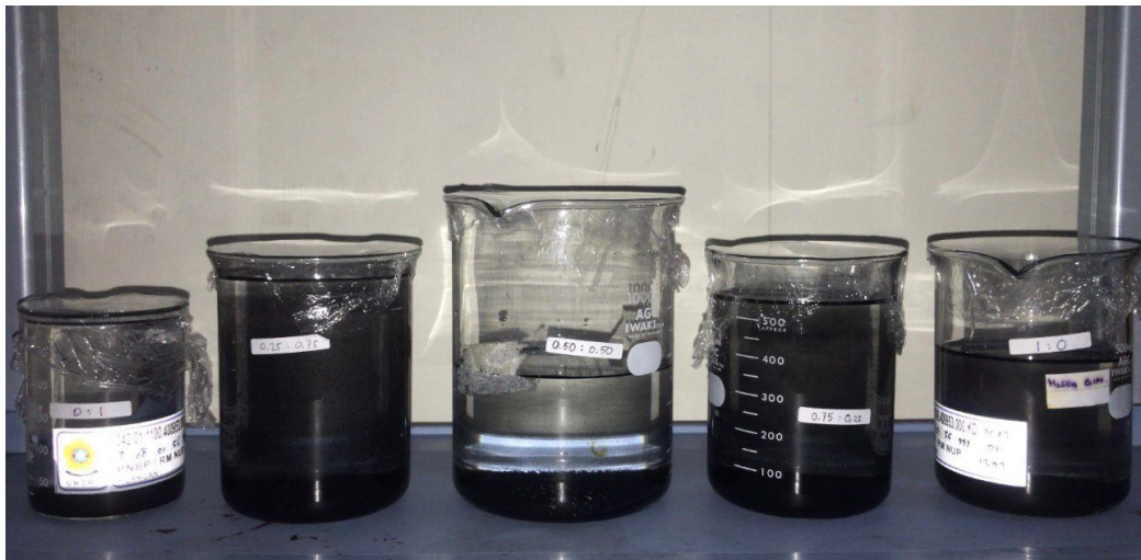
Gambar 1. Campuran hasil impregnasi katalis Pt dan Co pada matriks karbon dalam proses penetralkan
