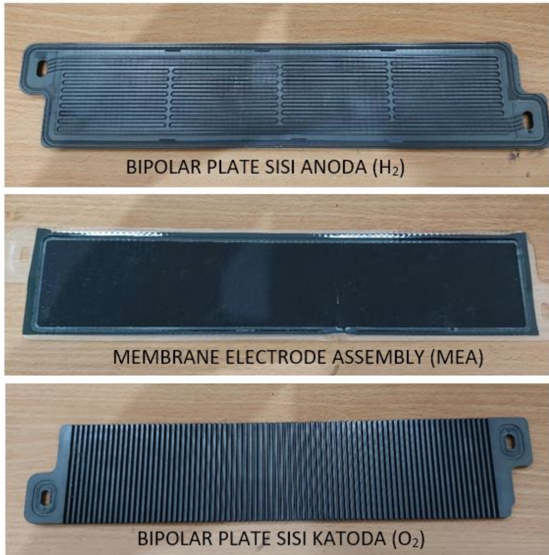
Gambar 4. Bipolar dan MEA dari stack PEMFC untuk BTS untuk diteliti
