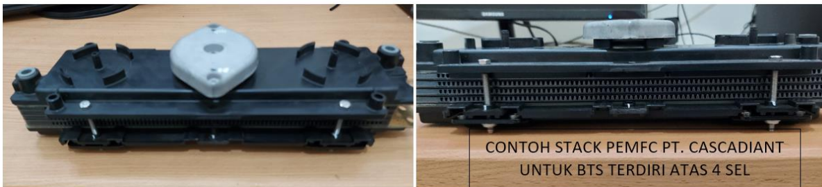
Peralatan stack PEMFC PT. Cascadiant yang berisi 4 sel untuk tes kinerja
