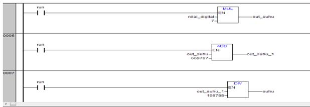
Gambar 17. Tampilan pemrograman *ladder diagram* untuk pembacaan suhu
