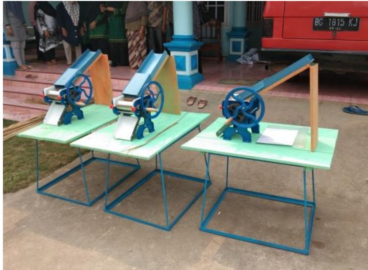
Tiga Unit Mesin Pemipih Purun Generasi Pertama untuk Desa Menang Raya Kecamatan Pedamaran Kabupaten Ogan Komering Ilir pada Tahun 2019
