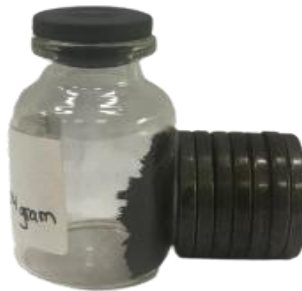
Gambar 5. Fe 3 O 4 hasil sintesis diuji dengan menggunakan magnet eksternal
