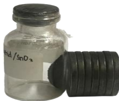
Gambar 7. Komposit \text{Fe}_3\text{O}_4 /kitosan-glutaraldehyd/ \text{SnO}_2 diuji dengan menggunakan magnet eksternal
