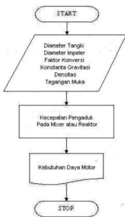
Gambar 2. Flowchart Perhitungan Kebutuhan Daya Pengaduk Pada Mixer dan Reaktor
