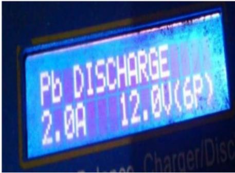
Gambar 9. Discharge Menggunakan Charger Lippo
