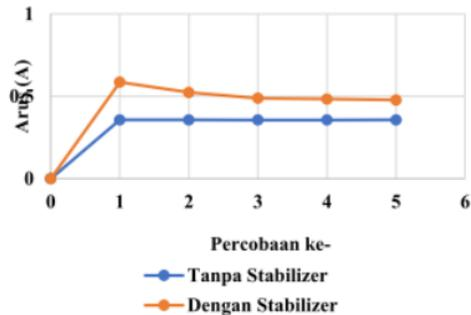
Gambar 8. Hasil sampel arus (A) pada baterai saat cuaca berawan dengan atau tanpa stabilizer
