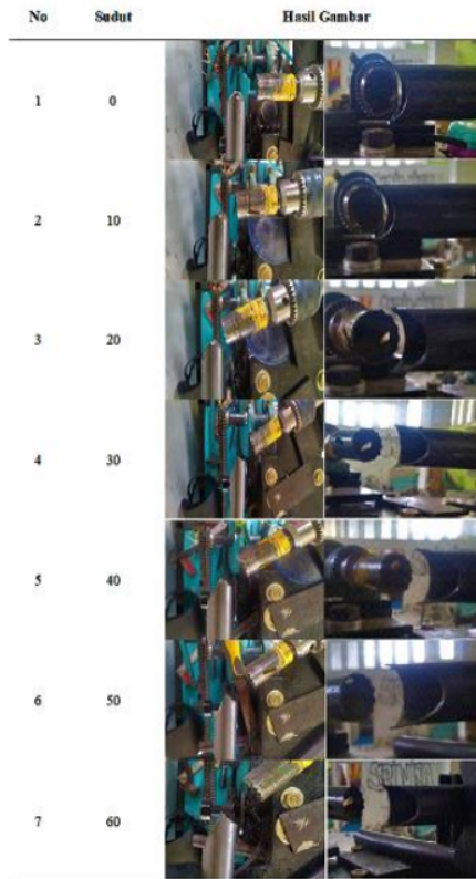
Gambar 16 Pengujian Notching dari 0° sampai 60°
