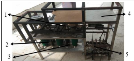
Keterangan: 1. Motor 2. Tempat pembersih sisik ikan (kasar) 3. Tempat pembersih sisik ikan (halus) 4. Tempat meletakkan komponen dan driver motor 5. Pemotong Ikan
